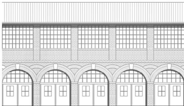
Élévation du magasin réhabilité
