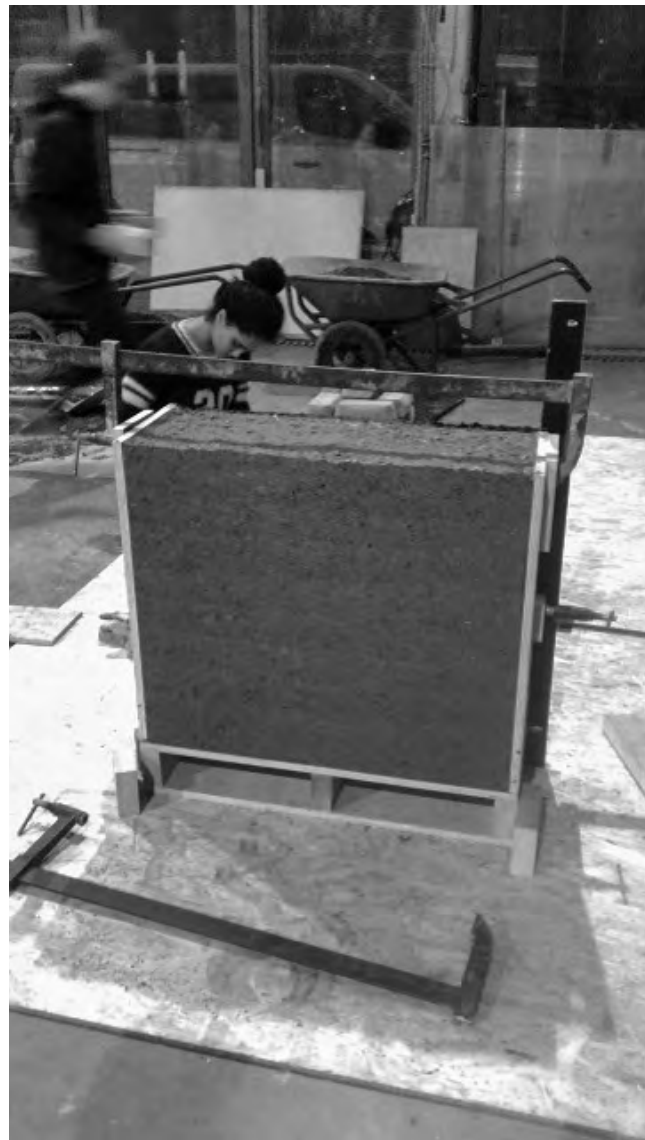
Expérimentation « matériau : pisé de mâchefer » à partir de terre et de cendres d'ordures ménagères, le laboratoire MATEIS et AMACO novembre 2018 — © : ENSAL.
