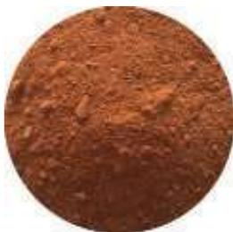
La terre rouge est située à 100 mètres du chantier du *tata*, à la surface du sol. C'est une terre fine présentant une très bonne répartition granulométrique de petits éléments. Elle offre un bon équilibre entre limons et argiles. Ses propriétés lui permettent d'être utilisée lors de travaux de finition notamment pour l'enduit de la dalle de la terrasse à l'étage.
