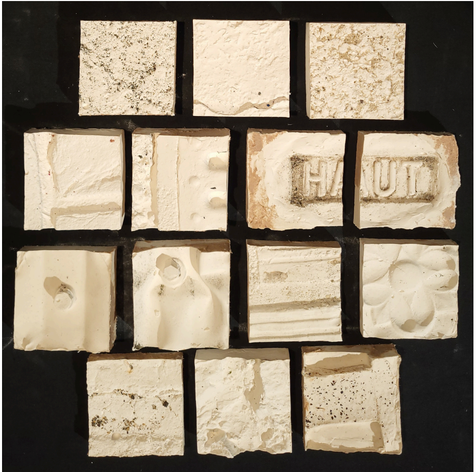
Figure 10 : Photographie des empreintes. De gauche à droite : gravier ; mur de clôture ; asphalt ; brique ; plaque d'égoût ; plaque industrielle ; plaque industrielle ; tôle avec écrou ; brique creuse ; tôle avec écrou ; ; motif sur tuile ; menuiserie métallique ; empreinte de schiste ; jointure
