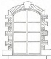
Les jambages des fenêtres en briques comportent un chaînage de 4 lancis
