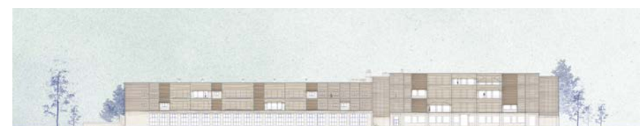
Façade et coursive, double peau
